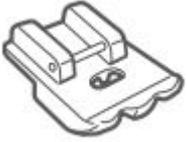
Ce pied permet, soit de réaliser un ruban passepoil, soit de poser du passepoil déjà prêt sur un ouvrage. Les deux sillons situés sous le pied guident le passepoil et le maintiennent fermement pendant la couture. Ce pied offre un rendu professionnel à vos projets déco ou à vos vêtements.
