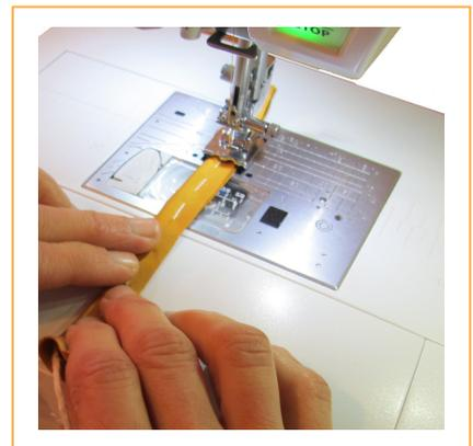
★ Poser le ruban passepoil que vous avez précédemment réalisé sur le tissu, endroit sur endroit, bords coupés vers la droite. Assurez vous que le bord du ruban passepoil soit aligné avec le bord du tissu. Abaissez le pied pour que le cordonnet du ruban passepoil s'emboîte dans le sillon de gauche sous le pied. Cousez le tissu tout en guidant le passepoil dans le sillon de gauche.
