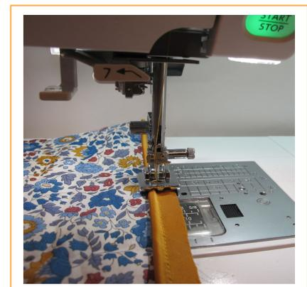
★ Pour insérer un ruban passepoil entre deux tissus, placer le tissu passepoilé sur l'autre, endroit sur endroit, bord à bord. Abaissez le pied pour que le cordonnet du ruban passepoil s'emboîte dans le sillon de gauche sous le pied. Réaliser une couture en s'alignant sur la couture visible (couture qui maintient le ruban passepoil au tissu)
